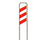
P-9 a Proximidad de un paso a nivel o de un puente móvil (lado derecho)
